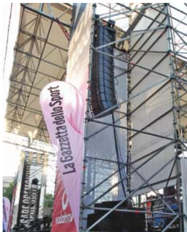
L'array composto da 12 Outline Butterfly CDH 483 Hi-pack e 8 sub Outline Victor Live (per ogni lato)
