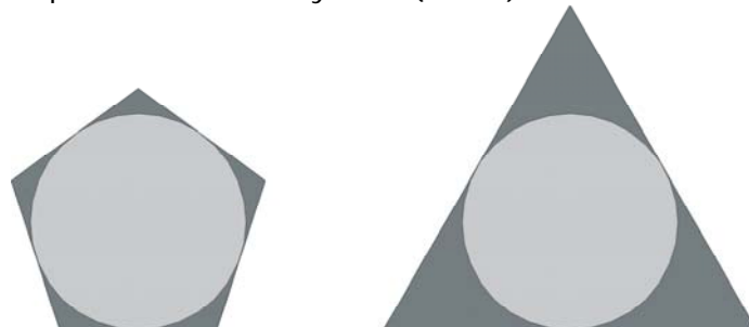
Bild 6: Vergleich Pentagon und Dreieckfläche bei gegebenem Lautsprecherdurchmesser.
